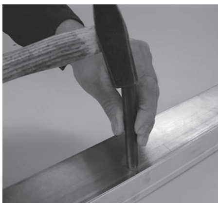
Einschlagen der Tülle mit Montage- werkzeug 499.318 und Stahlhammer (Achtung: Unterlagen verwenden) Frappe de la douille avec outil de montage 499.318 et marteau en acier (Attention: utiliser un support) Hammering in the insert with installation tool 499.318 and steel hammer (Important: use liners)
