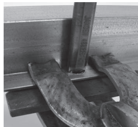
Reibwerkzeug 499.325 im Einsatz Comment utiliser l'outil d'alésage 499.325 Reamer 499.325 in use
