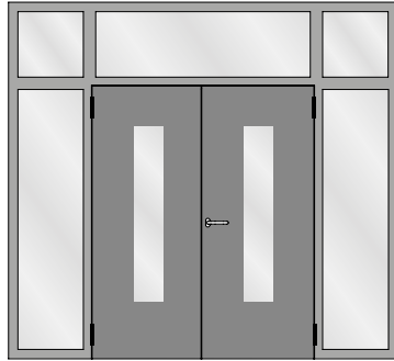
Verblechte zweiflügelige Türe mit zwei festen Seitenteilen und festen Oberlichtern Porte tôlée à deux vantaux avec deux parties latérales fixes et impostes fixes Sheet metal double leaf door with two fixed side lights and fixed top lights
