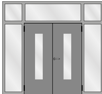
Verblechte zweiflügelige Türe mit zwei festen Seitenteilen und festen Oberlichtern Porte tôleée à deux vantaux avec deux parties latérales fixes et impostes fixes Sheet metal double leaf door with two fixed side lights and fixed top lights
