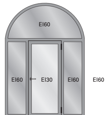
Einflügelige Türe mit zwei festen Seitenteilen und Rundbogen-Oberlicht Porte à un vantail avec deux parties latérales fixes et imposte demi-ronde Single leaf door with two fixed side lights and round arched top light
